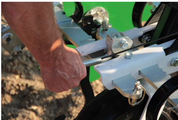
Abbildung 12: Fixierung der Zinkenbalken
