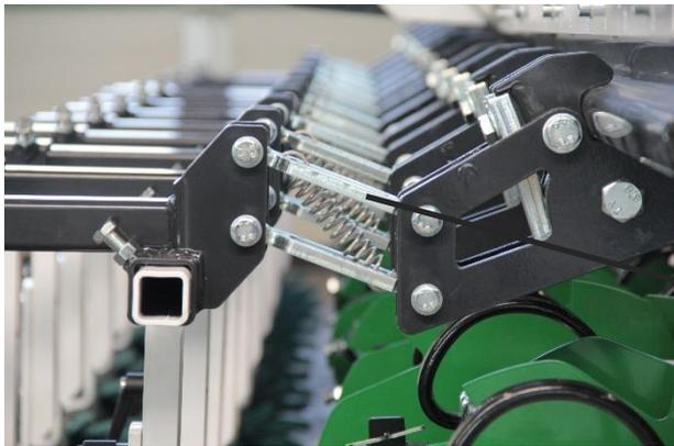
Parallelogramme mit vorgespannter Zugfeder
