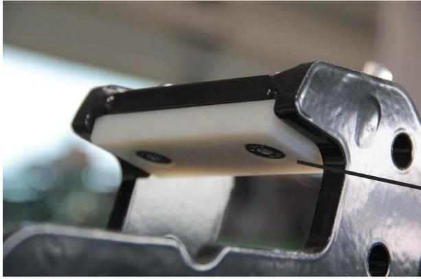
**Für ein gleitendes Verschieben der Werkzeugmodule.**
