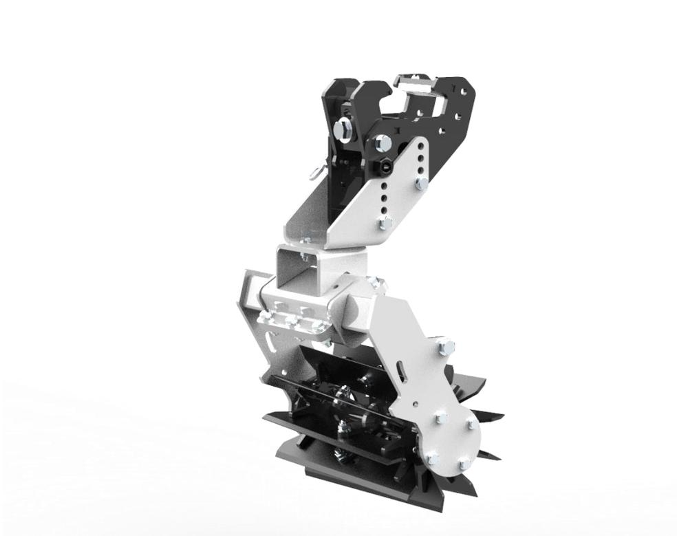
Das Reihenmesserwalzenmodul dient zur Zerkleinerung und zum Abdrücken organischer Masse. Das Modul wird über die Modulklemme am Variofield-Balken befestigt. Dazu bitte die Anleitung vom Hackmodul beachten. Die Modulhöhe kann in vier Stufen verstellt werden. Zudem kann durch eine Modul-Schrägstellung der Schnitteffekt erhöht werden. Die Ausweichsicherung passiert über eine Gummipuffer-Torsionsfeder. Die Lagerung der Messertrommel ist wartungsfrei und die Messerbreite beträgt 370 mm.
