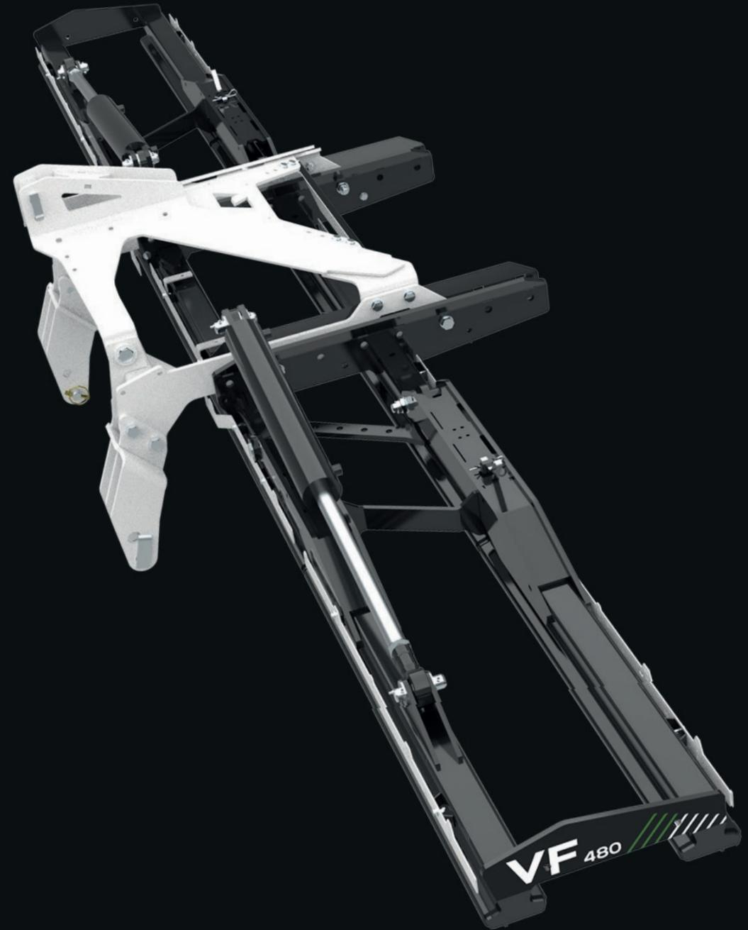
**PATENT** Das zweibalkige modulare Rahmensystem Variofield ermöglicht es erstmals, jeden Reihenabstand zu realisieren und steigert somit den Nutzen der Maschine um ein Vielfaches. Alle Variofield-Module sind kompatibel und lassen sich nach Ihren Bedürfnissen konfigurieren und jederzeit anpassen.
